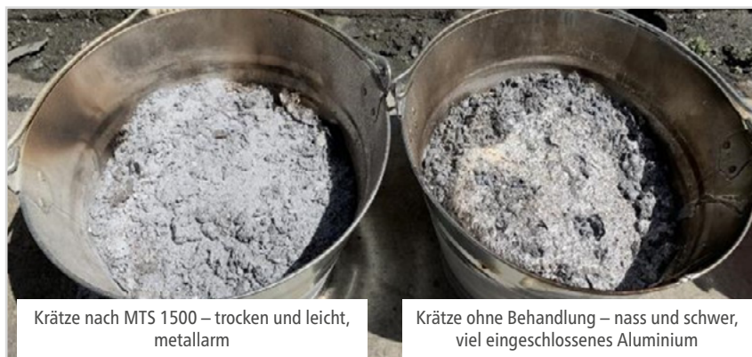
Abbildung 5 zeigt Krätze, die in einer sehr großen Druckgießerei für Automobilgussteile gesammelt und beprobt wurde
