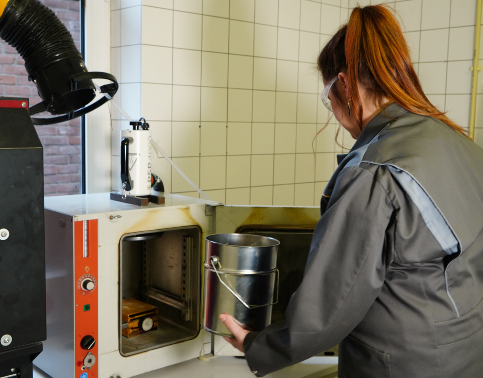
Foto 6: Formaldehyd-Emissionsmuster bei 150°C im Trockenschrank
