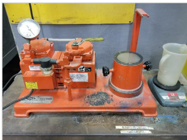
Abbildung 1. Abb. des UDIP-Geräts, das zur Bewertung der Entgasungseffizienz verwendet wird
