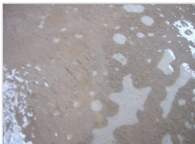
Foto 1. Mit Bakterien infizierter Schlichtebehälter
